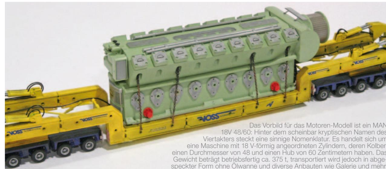
Das Vorbild für das Motoren-Modell ist ein MAN 18V 48/60: Hinter dem scheinbar kryptischen Namen des Viertakters steckt eine sinnige Nomenklatur. Es handelt sich um eine Maschine mit 18 V-förmig angeordneten Zylindern, deren Kolben einen Durchmesser von 48 und einen Hub von 60 Zentimetern haben. Das Gewicht beträgt betriebsfertig ca. 375 t, transportiert wird jedoch in abgespeckter Form ohne Ölwanne und diverse Anbauten wie Galerie und mehr.
